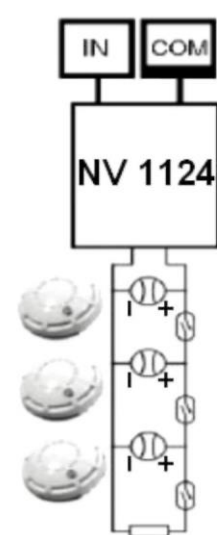
шлейф пожарных двухпроводных извещателей
